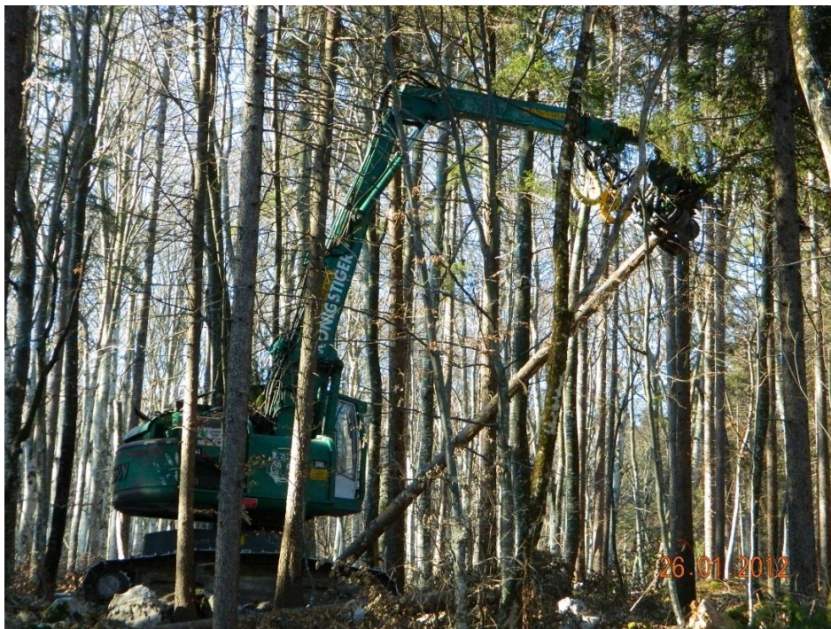
Slika 4: Gosenični stroj za sečnjo Königstiger pri delu v mlajšem debeljaku z mešano drevesno sestavo (avtor: E. Zabukovec)
